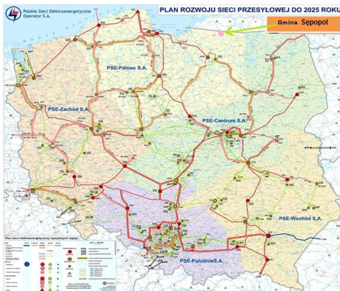
Rys. 4. Plan sieci elektroenergetycznej najwyższych napięć
