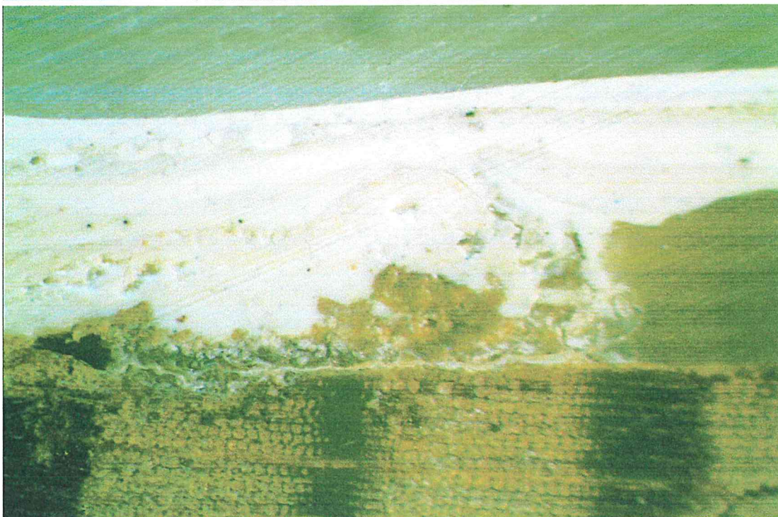
Przekrój próbki. Na powierzchni drewna widocznych jest 5 warstw białej farby.
