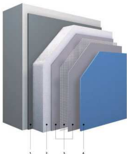
Rys. 1 Schematyczny przekrój systemu ociepleń (rys. Sto). 1 – zaprawa klejąca, 2 – termoizolacja, 3 – warstwa zbrojąca (zaprawa + siatka z włókna szklanego), 4 – wyprawa elewacyjna (tynk cienkowarstwowy); termoizolacja może być dodatkowo mocowana łącznikami mechanicznymi (kołkami)
